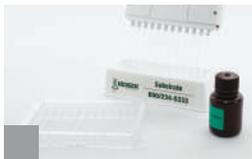
6. Agregar el sustrato a los pocillos con anticuerpos, incubar de acuerdo con el inserto del kit a temperatura ambiente.
