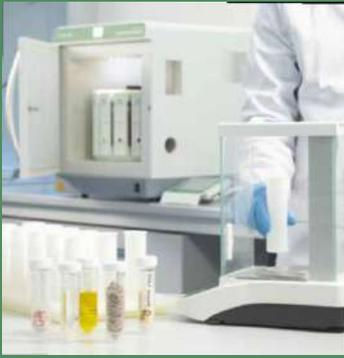
1. Etapa de pesado de la muestra en el vaso para Hidrólisis/Extracción en un solo paso.
